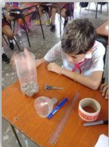
Confección de un pluviómetro casero a partir de una botella de plástico, una manera sencilla de medir cuánta lluvia ha caído
